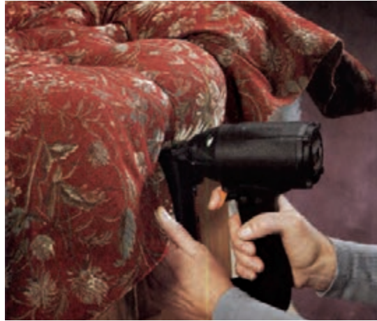
شکل ۴-۶۴- منگنه زدن لبه پایین
