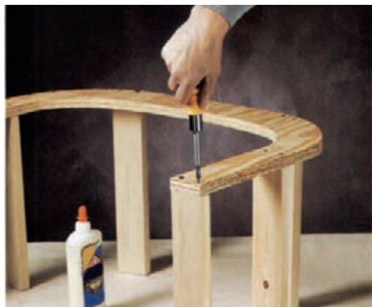
شکل ۲۱-۴- پیچ کردن قیدها به پایه
