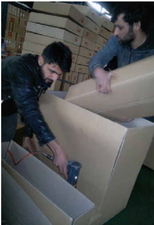
شکل ۶۷-۵- بستن کارتن با زدن منگنه
