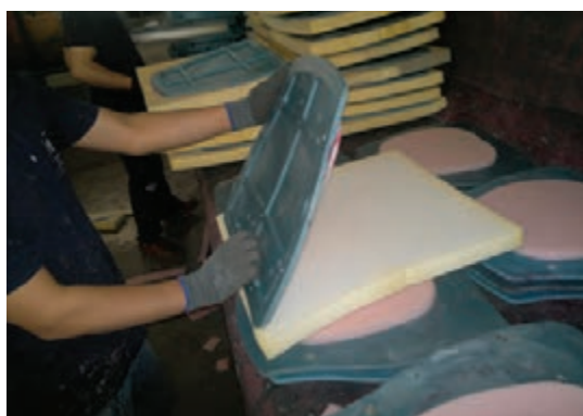
شکل ۵-۴۷- قراردادن کفی روی اسفنج بزرگ‌تر
