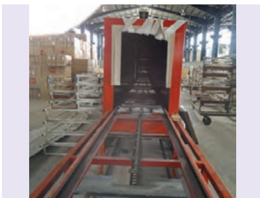
شکل ۳۹-۵- تونل خشک کن رنگ
