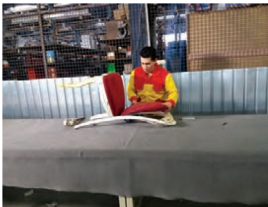
شکل ۷۸-۵- جا زدن پشتی
