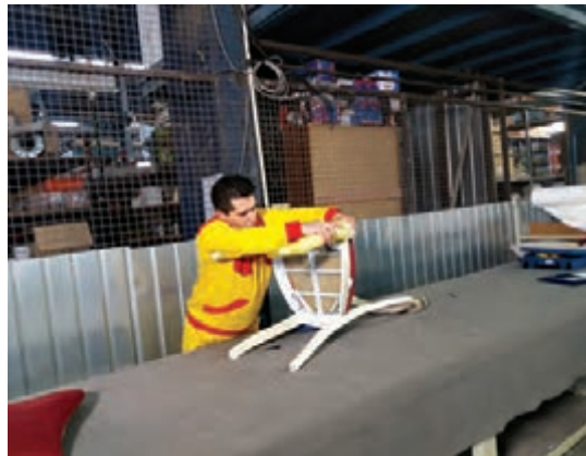
شکل ۷۷-۵- جا زدن و تنظیم پایه جلو
