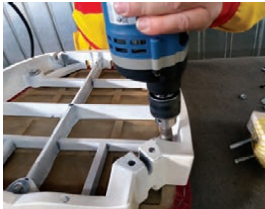
شکل ۵-۷۳- بستن شبکه زیر صندلی به کف
