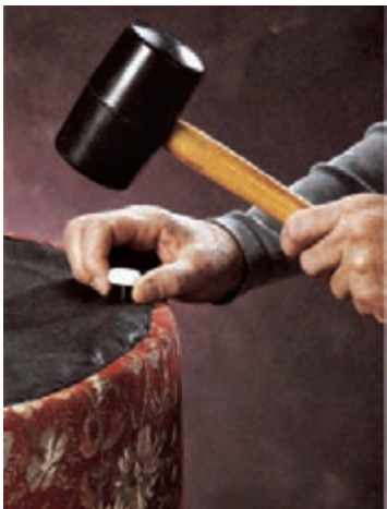
شکل ۴-۶۷- کشیدن و کوبیدن پارچه و کوبیدن اسفنج بدنه در زیر کف
