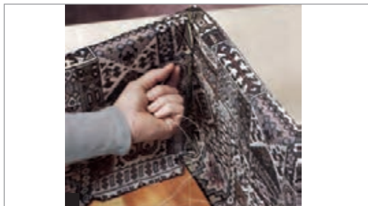
شکل ۴۱-۴- تنظیم پارچه و ثابت کردن آن در داخل صندوقچه شکل ۴۲-۴- دوختن درز گوشه با سوزن و نخ
