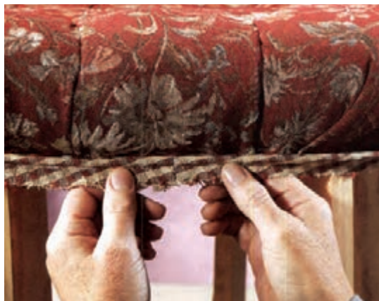
شکل ۴-۶۹- اندازه گیری و نصب سرمه
