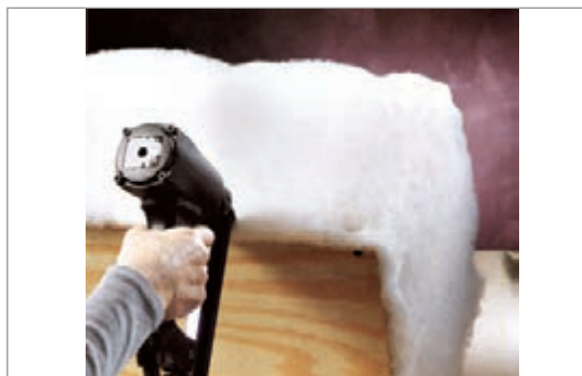
شکل ۴-۳۹- نصب اسفنج به بدنه صندوقچه
