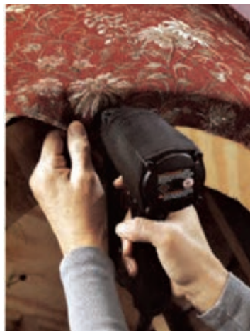
شکل ۴-۶۷- کشیدن و کوبیدن پارچه و کوبیدن اسفنج بدنه در زیر کف
