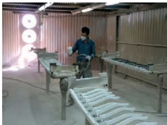
شکل ۳۶-۵- پاشیدن بتونه یا رنگ با پیستوله
