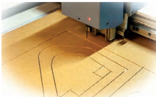
شکل ۵-۵۸- برش مقوا برای ساخت کارتن با سی‌ان‌سی
