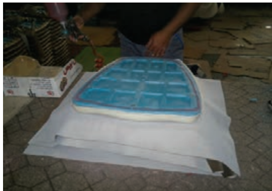
شکل ۵-۴۹ کشیدن پارچه روی کف صندلی
