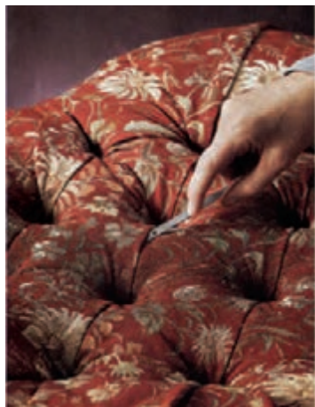
شکل ۴-۶۳- تنظیم لمسه با انتهای سوزن
