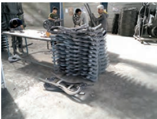
شکل ۳۲-۵ پرداخت کاری قطعات و چیدمان آنها
