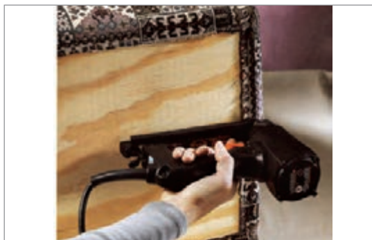
شکل ۴-۴۰- نصب پارچه در زیر صندوقچه
