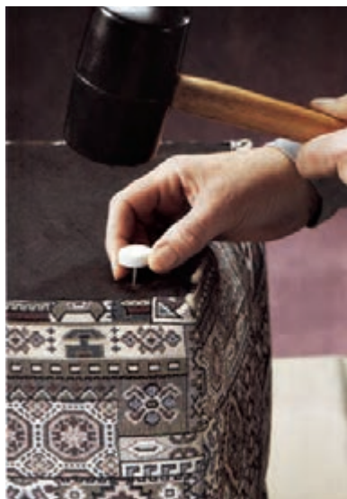
شکل ۴۳-۴- کوبیدن پایهٔ زیر کف
