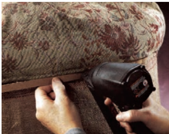
شکل ۴-۷۰- کوبیدن زهوار زیر سرمه با منگنه
