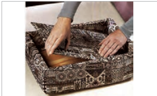
شکل ۴-۳۸- پوشش در صندوقچه از طرف داخل
